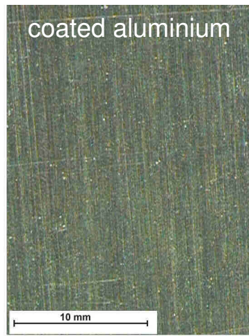
CVD-Quarz-Schutzschicht (kein Angriff feststellbar)
