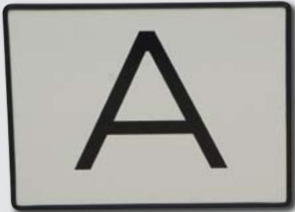
Warntafel für den Transport von Abfällen und Sondermüll, **starr**, 400 x 300 mm, aus verzinktem Stahlblech, Vorderseite Reflexfolie RA1, A, weiß, A schwarz gedruckt, mit Kanten-schutz schwarz
